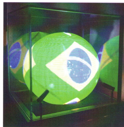
La sphère , un anneau composé de LED tournant à 30 tours/seconde, forme des images autour de la montre officielle de la Coupe du monde de Hublot.
