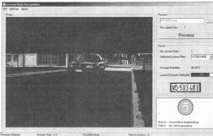
Le logiciel traitant les photos de radars routiers. L'interface permet ainsi aux limiers de la police. FiveCo a produit l'algorithme qui permet de repérer la plaque et de lire les caractères (à droite). ARCHIVES
